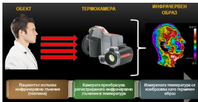
Фигура 2. Принцип на работа на инфрачервената камера
