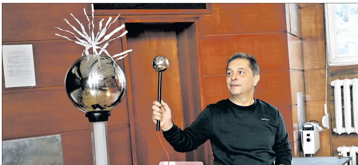
Гл. ас. Гошо Гоев нагледно демонстрира как може да се „изправи косата“ на метална сфера, към която се подава електрически заряд. „Косата“ е от лентички хартия
