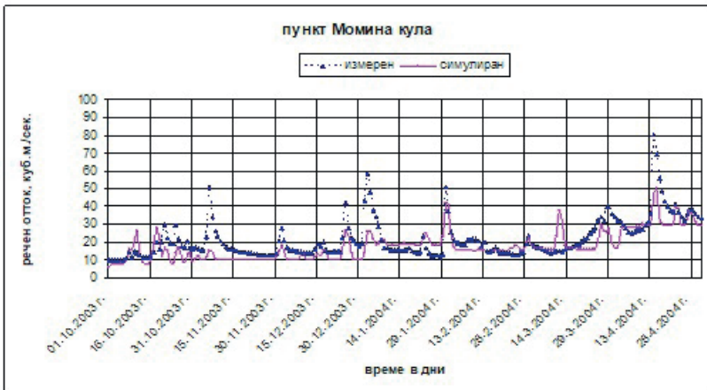
Фигура 6. Резултат за водния отток на река Места с измерени и изчислени с HEC-HMS данни в пункт Момина кула на 53,5 километра от границата с Гърция
