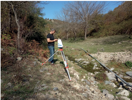
Фигура 1. Наземно лазерно сканиране на участък с проява на опасни геолого-геоморфоложки процеси: а) скален откос в Искърския пролом; б) участък с проява на кално-каменни порои – до с. Голяма бара, община Кърджали; в) участък с проява на поройни явления, водосбор на р. Дамдере, община Кърджали
