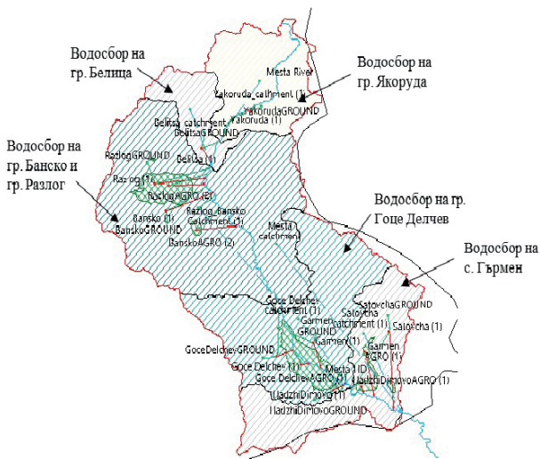
Фигура 7. WEAP схема на водосбора на река Места с показани консуматори на вода
