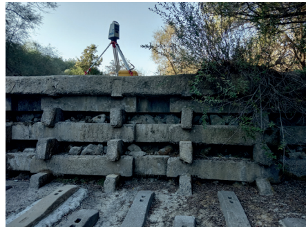
Фигура 1. Наземно лазерно сканиране на участък с проява на опасни геолого-геоморфоложки процеси: а) скален откос в Искърския пролом; б) участък с проява на кално-каменни порои – до с. Голяма бара, община Кърджали; в) участък с проява на поройни явления, водосбор на р. Дамдере, община Кърджали
