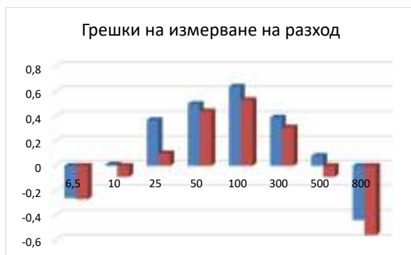
Фигура 1. Стойностите на получените грешки при измерването на разход на газ в определените точки на измервания
