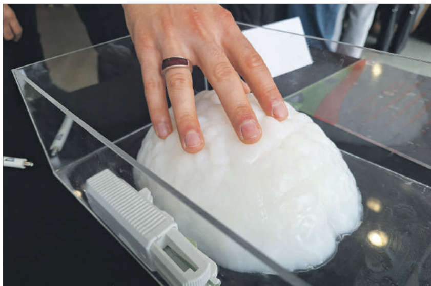
Мозъчен фантом – конструкция от гел, която наподобява физико-механичните свойства на мозъка
