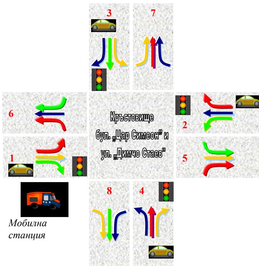
Фигура 2. Схема на преминаващите през кръстовището 8 номерирани потока МПС
