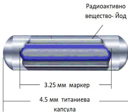
Фигура 1. Капсула – семе (размер: 4,5/0,8 мм.), съдържащо радиоактивен източник и радиографски маркер за по-лесна локализация посредством ЯМР
