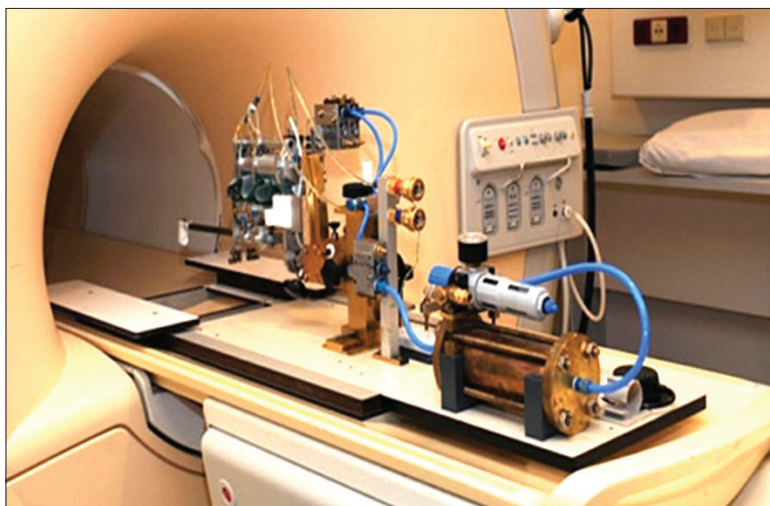
Фигура 2. Робот за въвеждане на радиоактивни семена. Процедурата се извършва по време на постоянен MRI (ЯМР)
