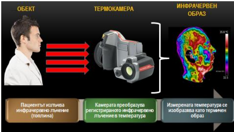
Фигура 2. Принцип на работа на инфрачервената камера
