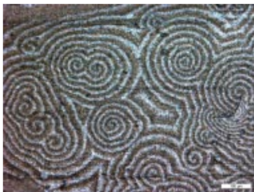
Електрохимично отложена сплав на кобалт и индий, любезно предоставена от Цветина Доброволска, ИФХ — БАН
